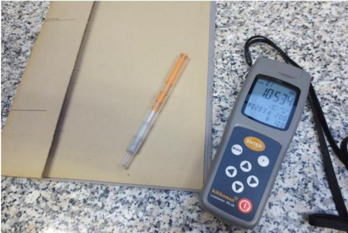
Abb. 1 ATP/AMP Messung mittels Messstäbchen
