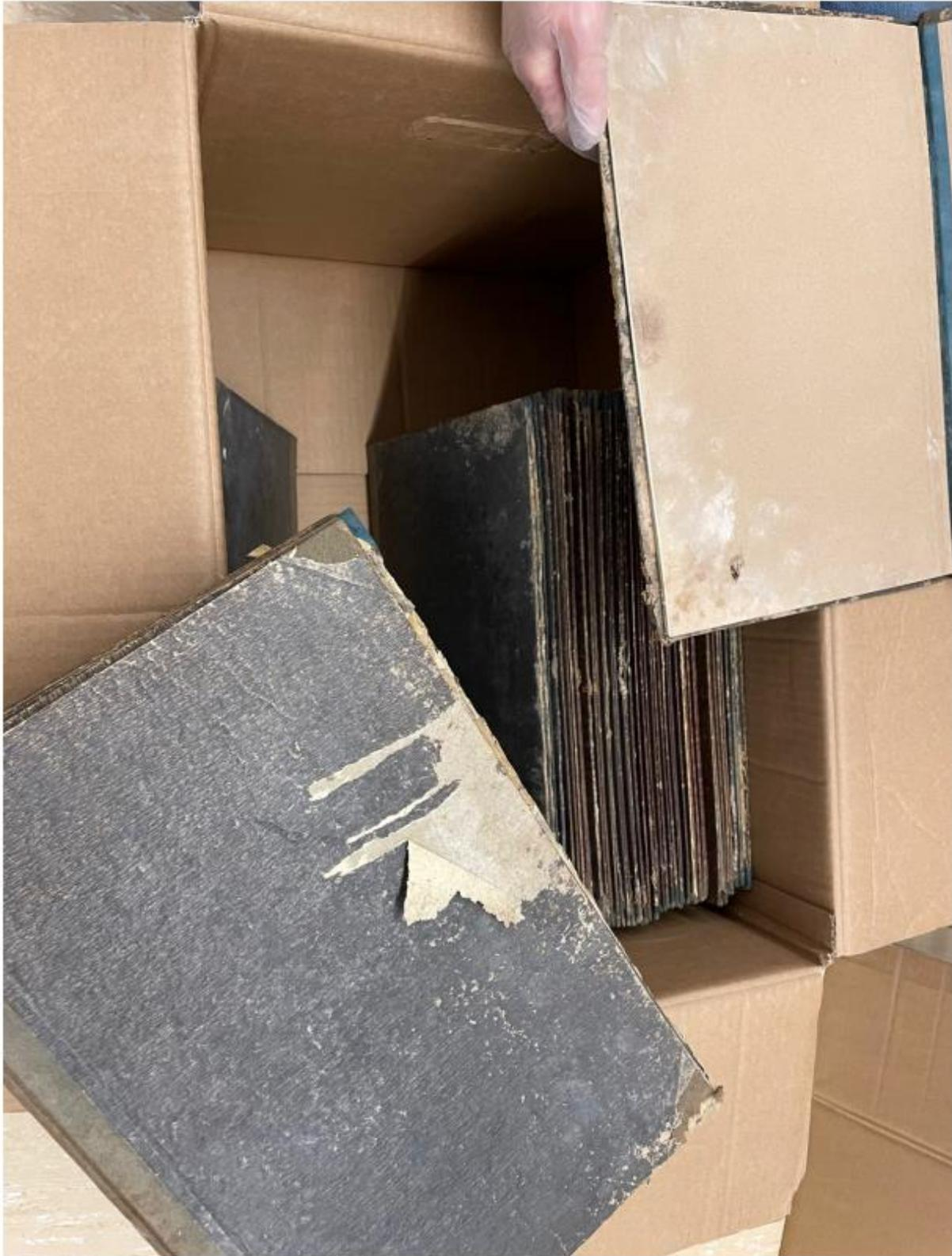
Abb. 8 Beschädigte Akte (Wasserschaden und Schimmelbefall) Schadensklasse 3 außen
