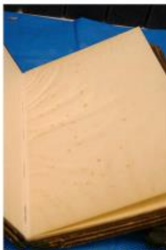
Abbildung 6: Standesamt-Zweitbuch, geöffnet. Verwerfungen und braune Stockflecken in dem Papier sind ein Hinweis auf die ehemalige Anwesenheit von Feuchtigkeit.
