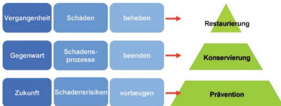
Abb. 1: Grundlegende Strategien der Bestandserhaltung
