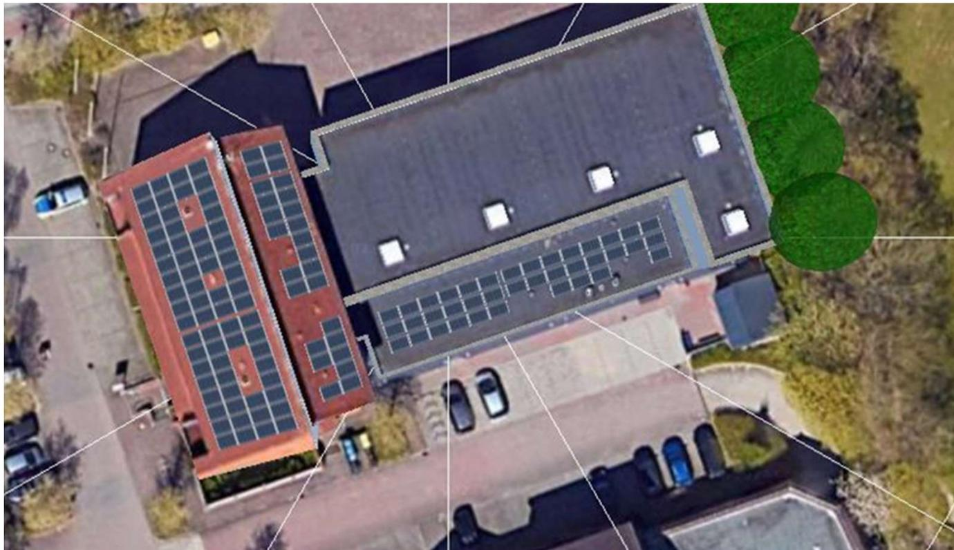
Die zur Verfügung stehende Dachfläche wurde maximal belegt. Die PV-Module wurden auf zwei Anlagen aufgeteilt.
