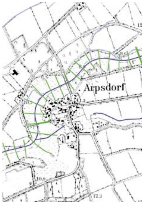
Abb. 6: Vergleich: Profile für 1d-Hydraulik und Finite-Elemente-Netz für 2d-Hydraulik (Abbildungen aus dem Pilotprojekt „Abgrenzung der Überschwemmungsgebiete im EZG der Stör“;TUHH)
