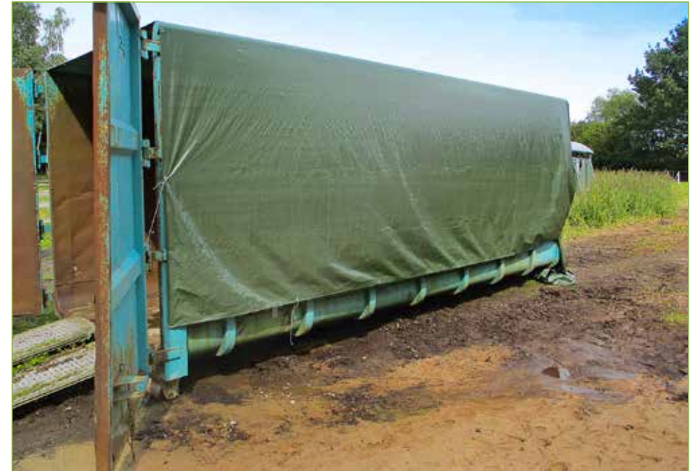
Bild 12: Abgedecktes mobiles Pferdemistlager
